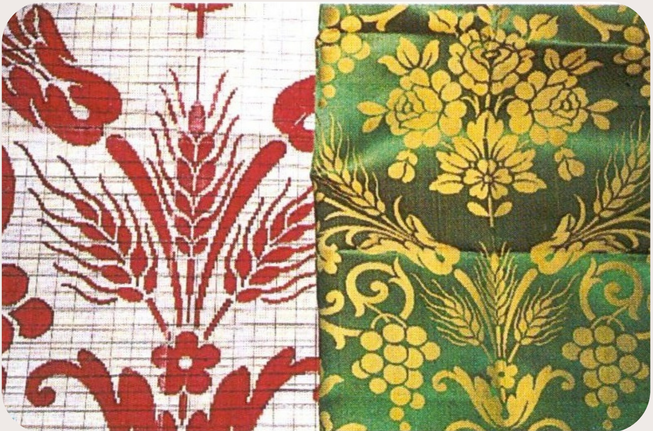
Messa in carta tecnica di un tessuto operato e relativo campione
